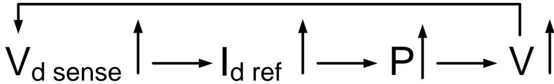
**Fig. 2. 11 Diagram of magnitude of voltage feedback in dq frame**
