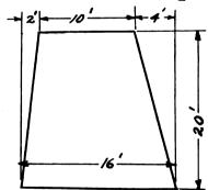
Volume concrete= $2(10+16) \times 20 \times 25$ ) =485 cu. yd.
