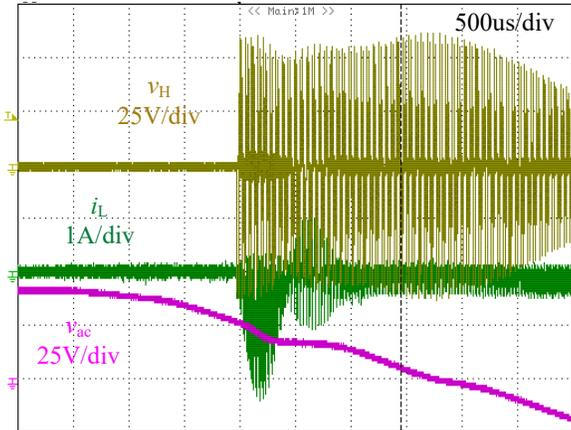
(d) Startup at the falling edge of the AC voltage
