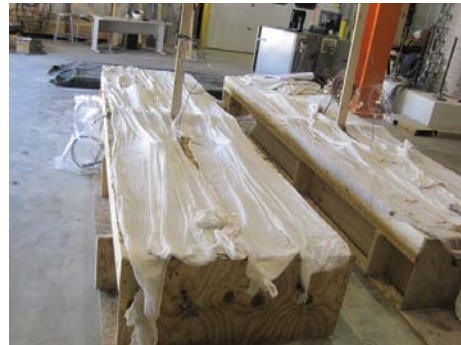
(d) Curing of fabricated T-beams
