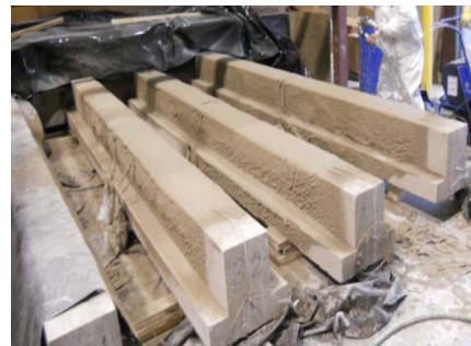
(d) Insulated beams for curing
