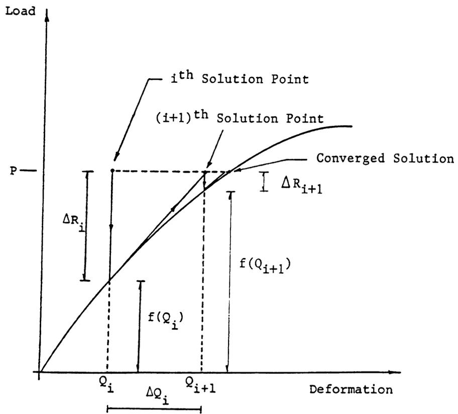
Figure 3-1 : NEWTON-RAPHSON ITERATION
