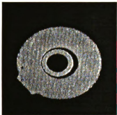
(d) Image of defective casting labeled "Blow-Hole 2".
