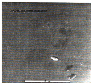
(d) Implantation with abrasion (60 min) ( 2 \times 10^{17} \text{ Mg}^+ \text{ cm}^{-2} )
