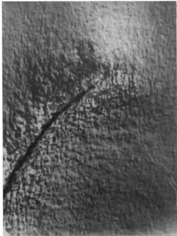
Fig. 9 : Crack Tip Morphology in DS-Nickel
