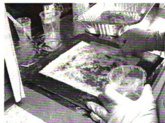
(d) Wet-out of bottom mat layer
