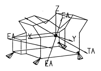
ELASTIC & TORQUE AXES
