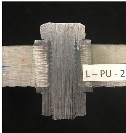
(d) Hybrid joint with polyurethane
