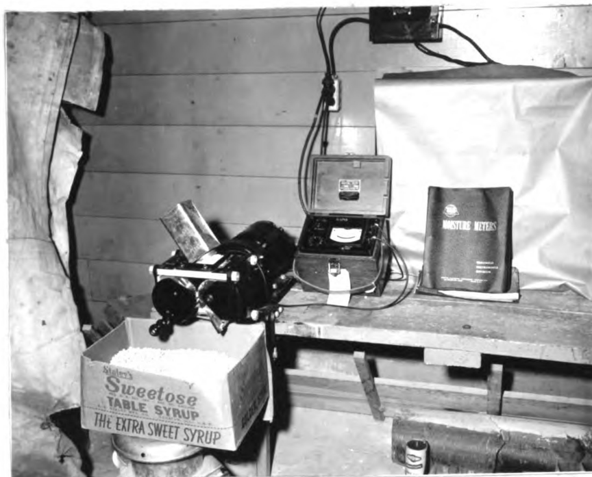
Fig. 20. Tag-Heppenstall Moisture Tester
