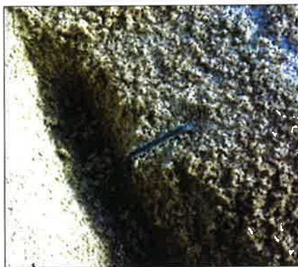
Dukene under sanden på Losby var festet godt med kramper, men det hjalp ikke når frosten løftet dem opp igjen. Dukene er nå skriftet ut. En dyr erfaring. Foto: Alex Cawley.
