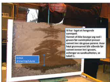
Vannet vil ikke bevege seg fra fine porer inn i grove porer før vanntrykket er så stort at vannet presses inn i dem.
