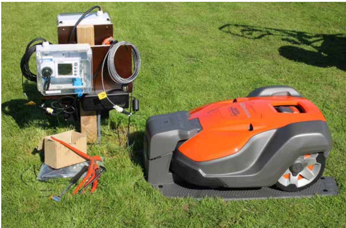
Foto 3: Klipperobot i ROBO-GOLF prosjektet. Ved hver ladestation er det installert en logger, der måler energiforbruket. Foto: Anne F. Borchert.
