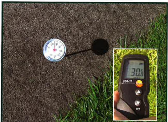
Det var ekstremt varmt da gressmatta ble lagt ut. Bladtemperaturen var over 30 grader. Jordtemperaturen over 25. Dette gir plantene stress.
