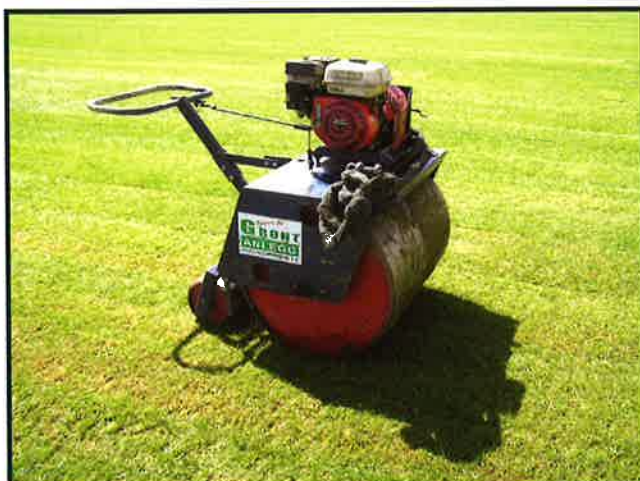
Etter legging ble gresset valset skikkelig for å sikre god jordkontakt
