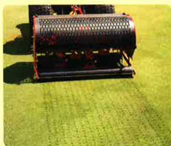
Verti-Drain's parallelogram løser opp hardpakket jord.
