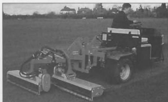
**Pro-sweep** er en hydraulisk drevet feiemaskin designet for effektiv nedbørsting av dressematriale. Maskinen fungerer også svært godt tilrensing og lett vertikalskjæring av gressmatta.
