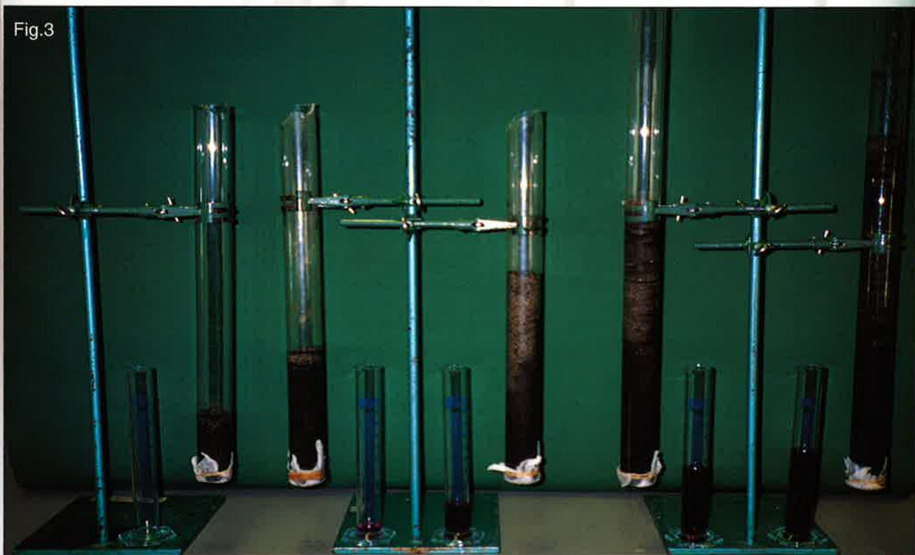
Forsøk med avrenning fra sandsøyler med ulik høyde. Vannet er farget for å synes på bildet.
